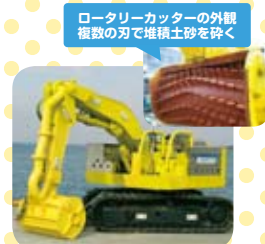
ロータリーカッターを装着した油圧ショベル (写真提供：東亜建設工業株式会社)
