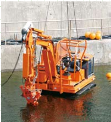
音響ビデオカメラが取り付けられたROV。実験時、クレーンで水中に沈められる
