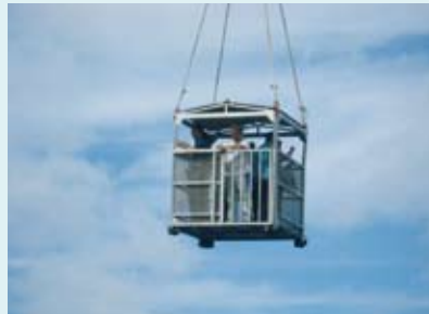
クレーンによる乗船客の乗り降り
